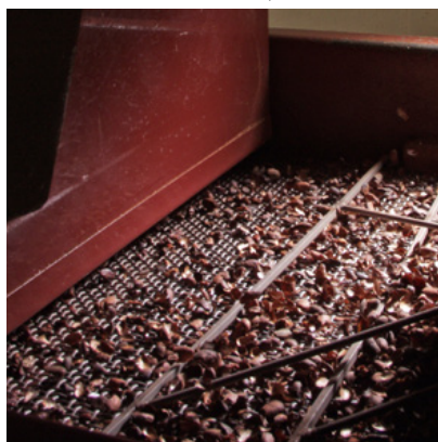
TRENNUNG VON SCHALEN & KERN
